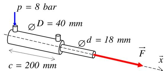
**c)** Calculer l'aire  $S$  de la surface sur laquelle la pression pneumatique s'applique.
