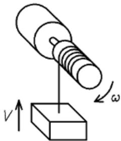
On considère un système de levage composé d'un moteur à courant alternatif alimenté sous une tension efficace  $U = 230\text{ V}$  et d'un câble s'enroulant sur un cylindre entraîné en rotation par le rotor du moteur.
